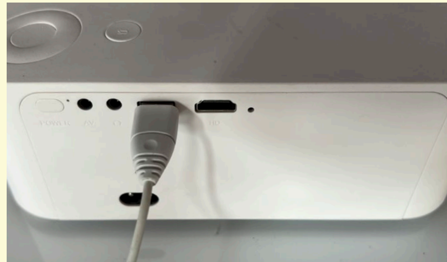
Conectaremos los altavoces al videoprojector a través del conector USB
